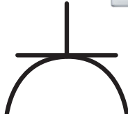
Розетка двухполюсная сдвоенная для скрытой установки, IP20-IP23
