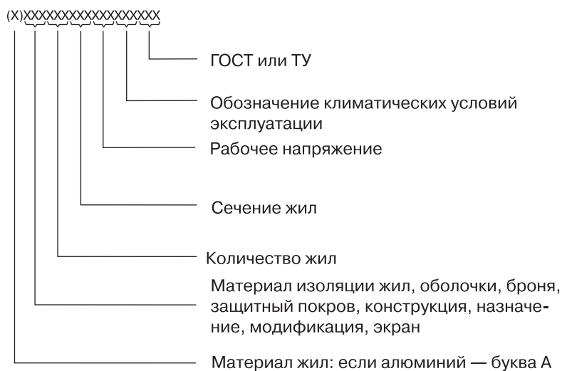
Структурная схема буквенно-цифрового обозначения кабельных изделий. Ввиду огромного многообразия видов кабельных изделий, изготавливаемых как по общегосударственным, так и по отраслевым техническим условиям и стандартам, схема может иметь и иной вид.
