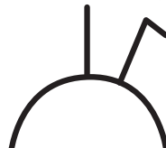
Блок: розетка + выключатель для скрытой установки, IP20-IP23
